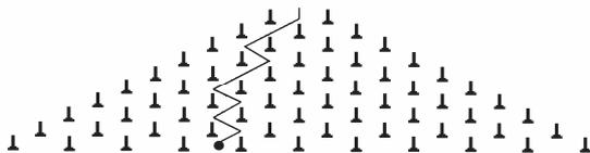
**Fig. 2.** Esperimento di Galton sulla casualità degli urti [B.20]; la distribuzione delle cadute della particella è di tipo Normale se consideriamo un numero infinito di prove e una macchina costituita da un numero infinito di linee di ostacoli.
